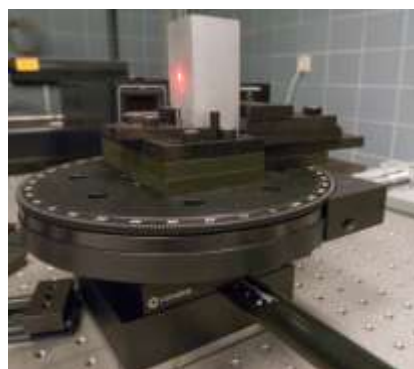
Obr. 2: Detailní pohled na zkoumaný předmět umístěný na speciálním aparátu, který obsahuje translační a rotační stolek.
