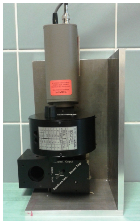
Kamerový systém pro analýzu laserového svazku.
