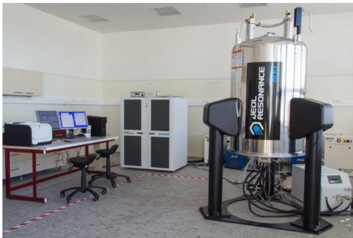
JEOL JNM-ECA 600 II NMR spektrometr
