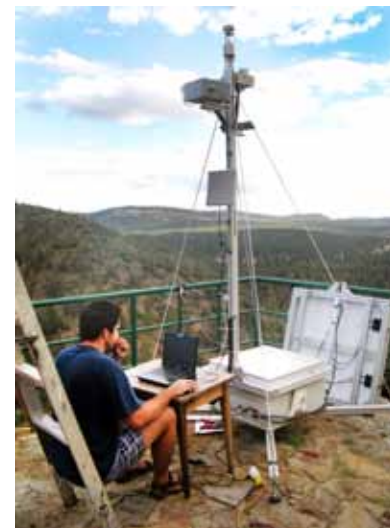
Kalibrace a justování celoblohové kamery v lokalitě San Pedro Mártir (Mexiko)
